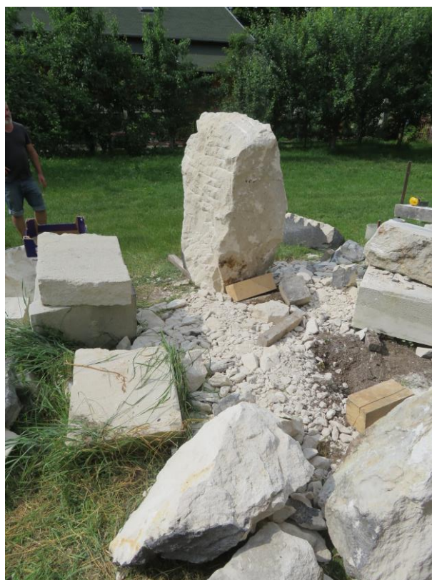
A nyári kőtömb hasogatás, aminek a végén le kellett mondjunk a kiszemelt darabról az addig rejtve maradt repedések miatt.
