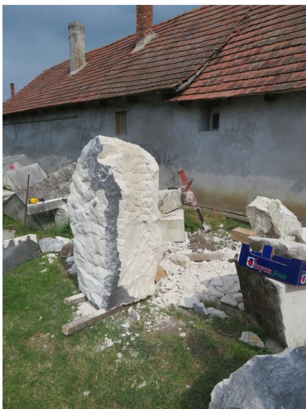
A nyári kőtömb hasogatás, aminek a végén le kellett mondjunk a kiszemelt darabról az addig rejtve maradt repedések miatt.
